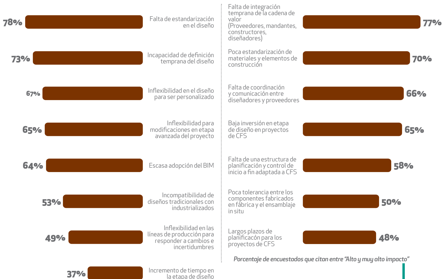
GRÁFICO N°09 BARRERAS DE DISEÑO Y DESARROLLO QUE INHIBEN LA ADOPCIÓN DE LA CONSTRUCCIÓN FUERA DE SITIO
